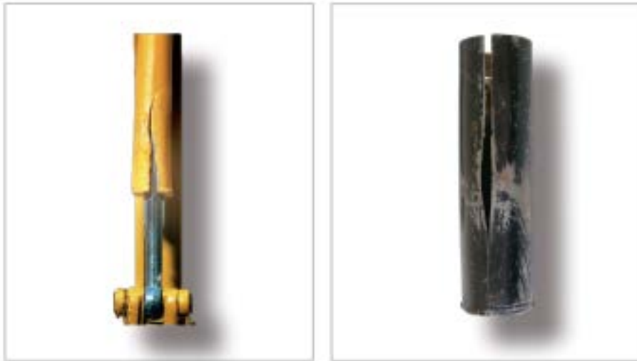
» Abb. 4: Druckübersetzung Differenzialzylinder: Achtung bei der Druckübersetzung!
