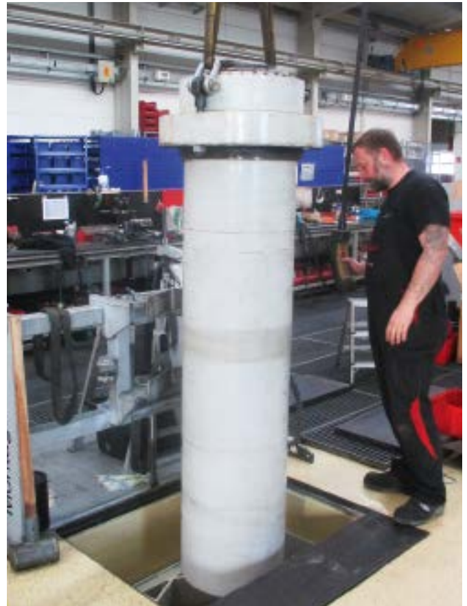
» Seit Neuestem ist in der Werkstatt ein Montageloch eingebaut, das die senkrechte Montage und Demontage von Zylindern erlaubt.
